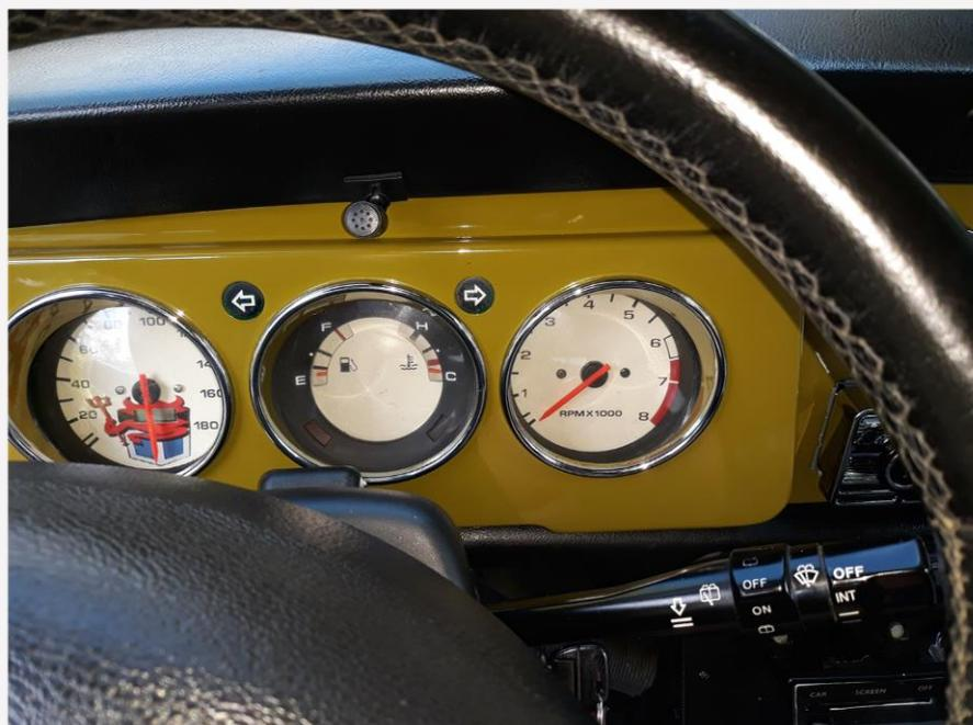
Original MPI 98 Armaturen, Tachoeinheit von mechanisches auf elektronisches Signal umgebaut und mit neuer Tachoeinheit (883er Harley Sportster) ausgestattet.
