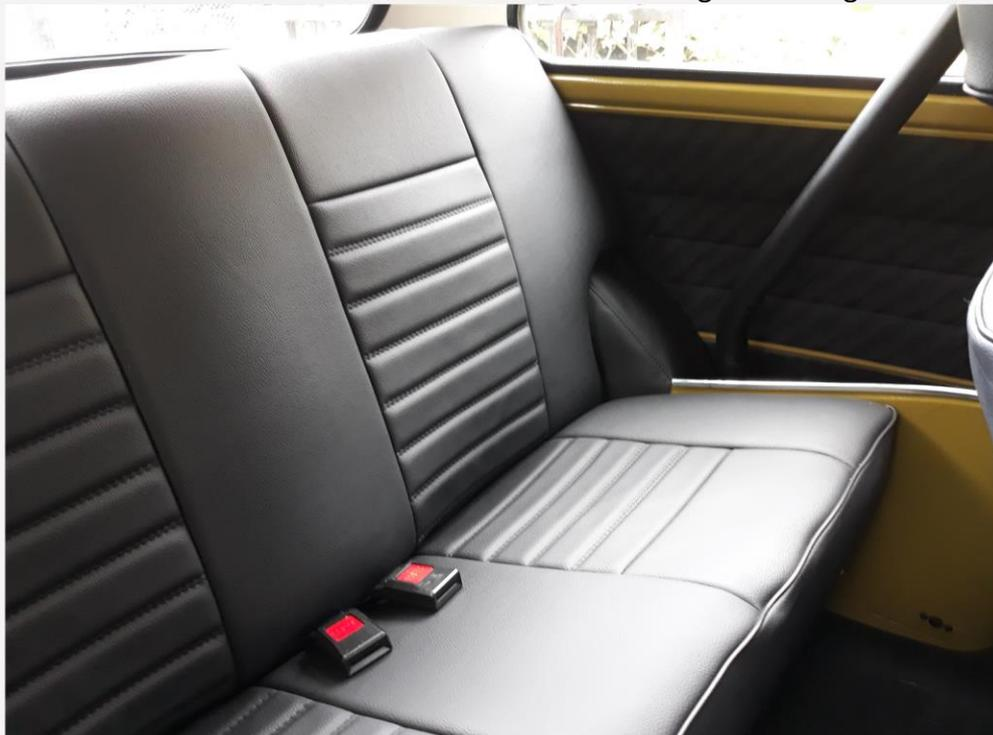
Auf Maß gefertigter Aussteifungsrahmen, in Teilen demontierbar, durch Fa Fischerleitner dimensioniert und gefertigt. Mit Schaumstoff gepolstert und mit Kunstleder überzogen.
