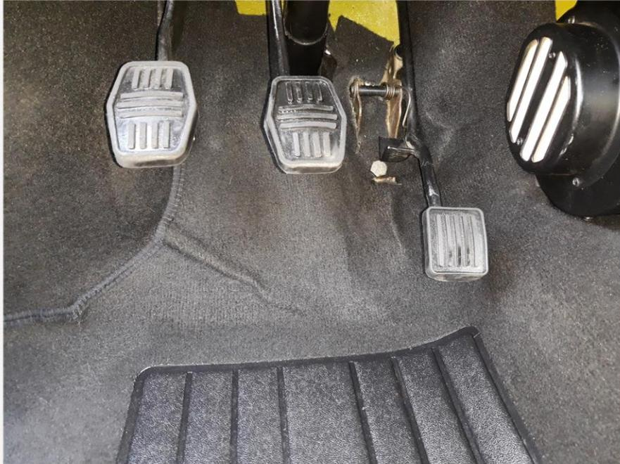
Pedalerie original Suzuki inkl. Bremskraftverstärker optisch auf Mini Pedalerie angepasst.
