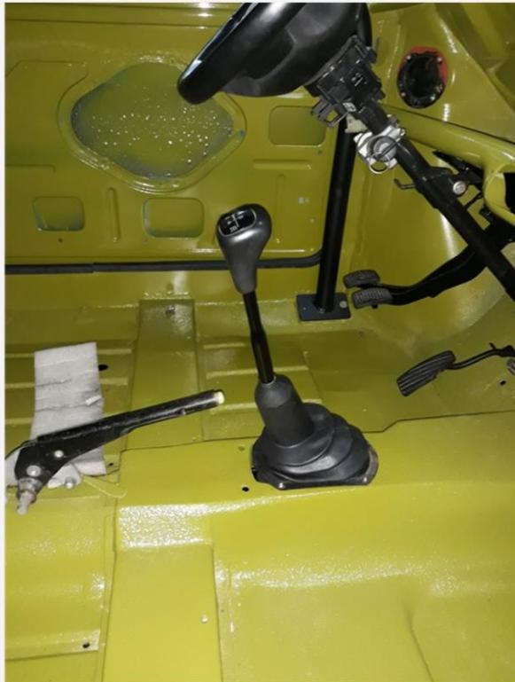
Karosserieinnenraum von Grund auf saniert, teilweise durch neue originale Einschweißbleche ersetzt, Querholm um 5cm tiefer gesetzt, Getriebetunnel für Suzuki Getriebe adaptiert, Bleche verzinkt, grundiert, lackiert, hohlraumversiegelt. Schaltung von Suzuki auf Mini adaptiert.
