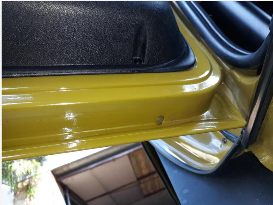
Türen generalüberholt ,Türfälze überarbeitet, Schadstellen durch Neuteile ersetzt, verzinkt, grundiert und neu lackiert, Hohlraum versiegelt.
