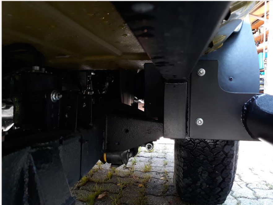
Aufhängung Unterfahrerschutz am Adapterrahmen durch Fa Fischerleitner.
