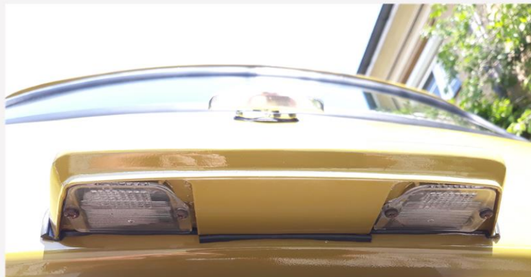
Originale beheizte Heckscheibe, verchromter Kofferraumgriff, originale Kennzeichenbeleuchtung in Wagenfarbe.
