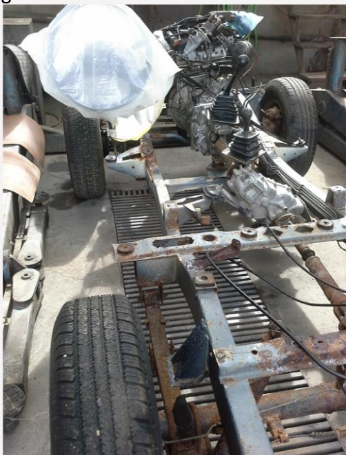
Basis : Suzuki Samurai Rahmen und Motor vor Restaurierung, Fahrgestell und Antriebseinheit Suzuki SJ413 Samurai BJ 1987
