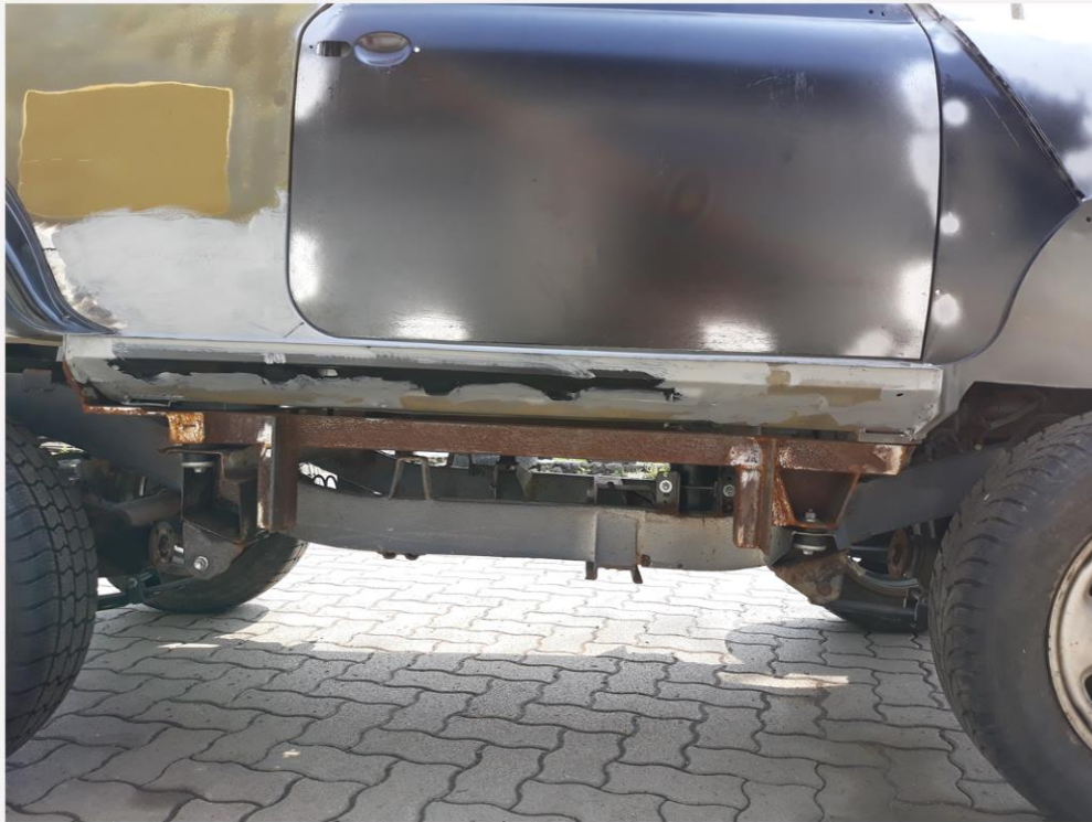
Schweller entrostet, schadhafte Stellen mit originalen Reparaturblechen ersetzt. Außentürbleche, Dreiecksbleche, Kotflügel durch Neuteile ersetzt.
