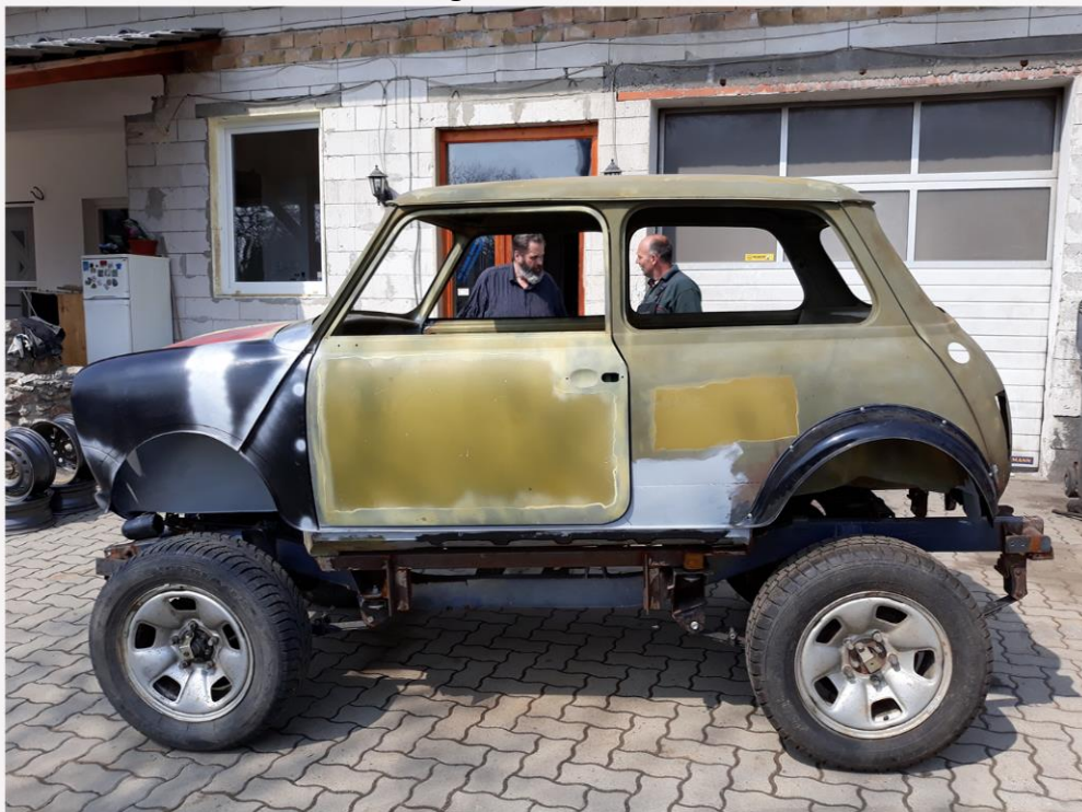
Schweller entrostet, schadhafte Stellen mit originalen Reparaturblechen ersetzt. Außentürbleche, Dreiecksbleche, Kotflügel durch Neuteile ersetzt.
