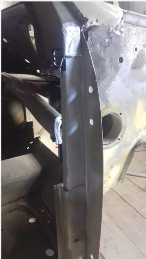
Unfallschaden an A-Säule behoben und durch originale Reparaturbleche ersetzt
