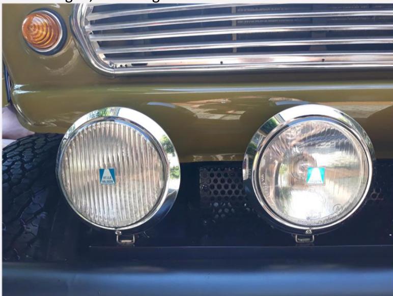
4 generalüberholte Chrom Retro Zusatzscheinwerfer "Hella" 2x Fern und 2x Nebel auf Zusatzscheinwerferhalter Fa Fischerleitner.
