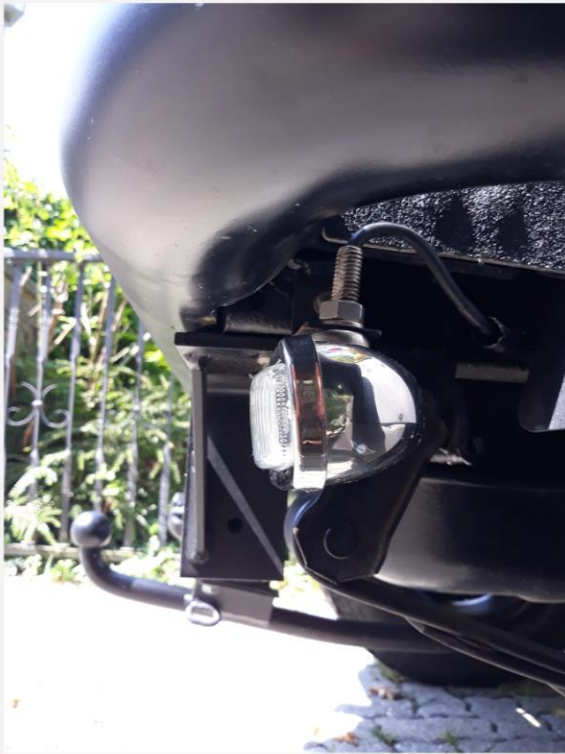
Original Suzuki Brink Anhängerkupplung mit bis zu 1100kg Anhängelast.
