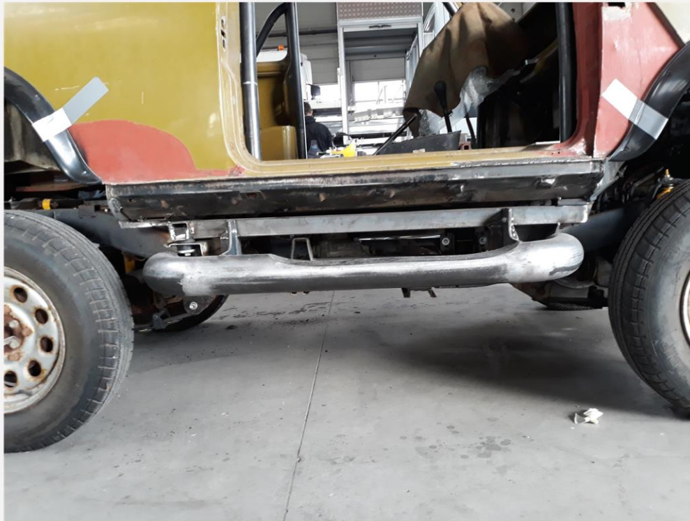
Adapterrahmen durch Fa. Fischerleitner
