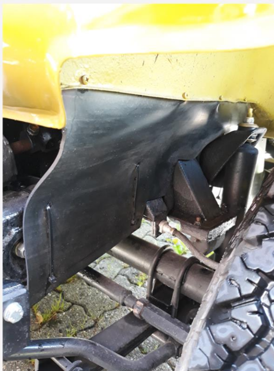
Motorraum Spritzschutz Eigenbau aus Kunststoffmatten.
