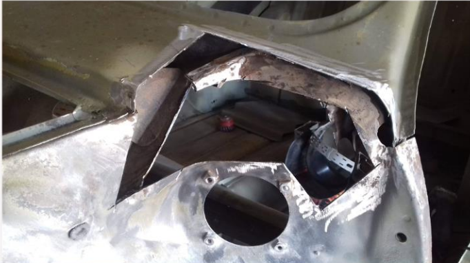
Prinz Heinrich Blech generalsaniert, schadhafte Stellen durch orig. Reparaturbleche ersetzt
