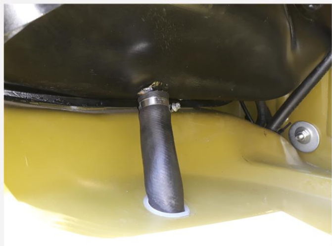
2 neue originale Mini Rücklichtzylonen (mit Reflektor) mit Chromrahmen. Original 30l Austin Mini Tank mit original 70l Suzuki Tank verbunden, Tankvolumen 100l !
