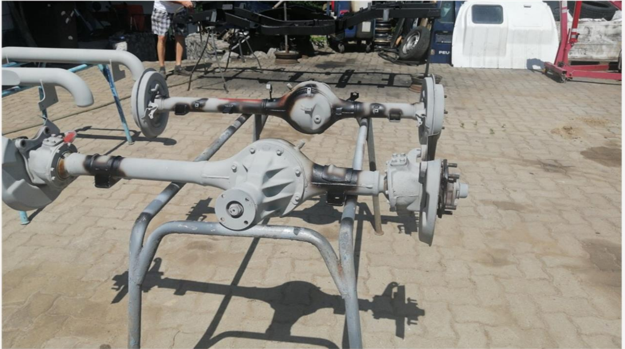
Achsen und Rahmenteile entrostet und spritzverzinkt.
