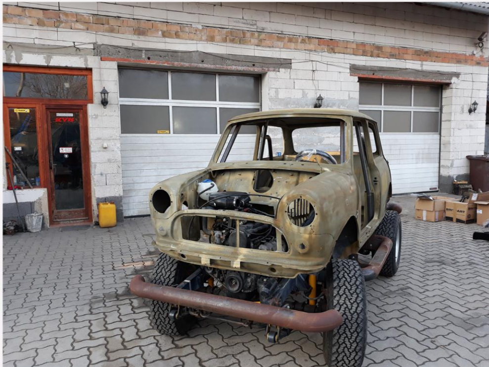
Karosserie mit Schutzbeschichtung
