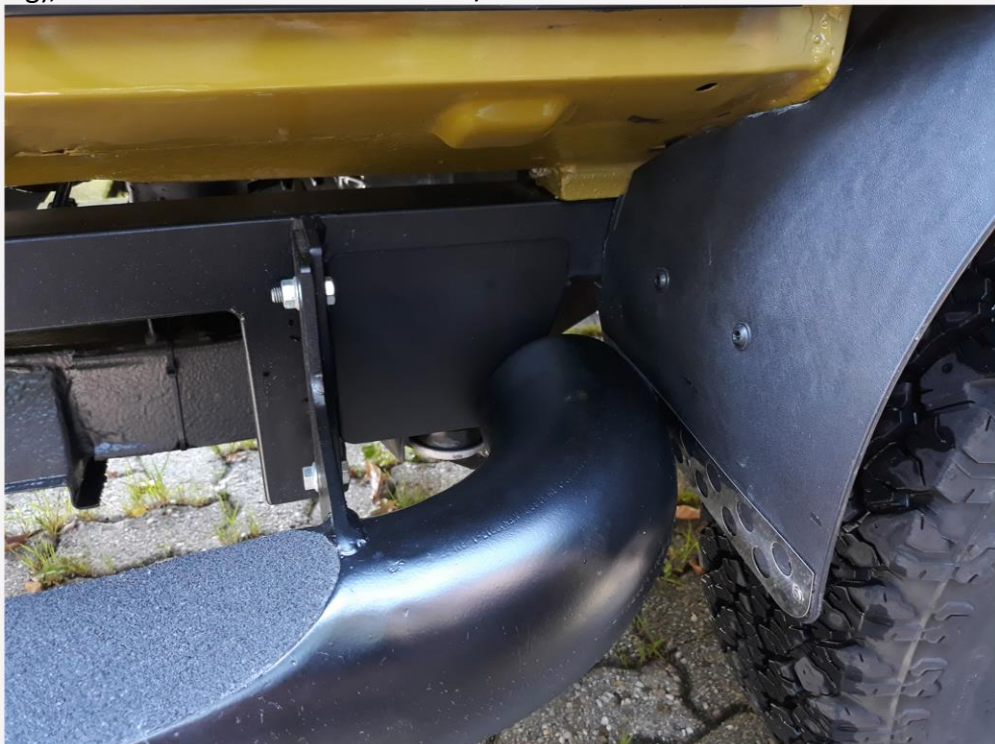
Adapterrahmen zwischen unteren Aufnahmepunkten Suzuki und oberen Aufnahmepunkten Mini Karosserie (verstärkt) durch Fa Fischerleitner, (Foto vorderer Bereich mit und ohne Abdeckung), mit seitlichem Unterfahrschutz / Seitenschweller mit Trittstufe.
