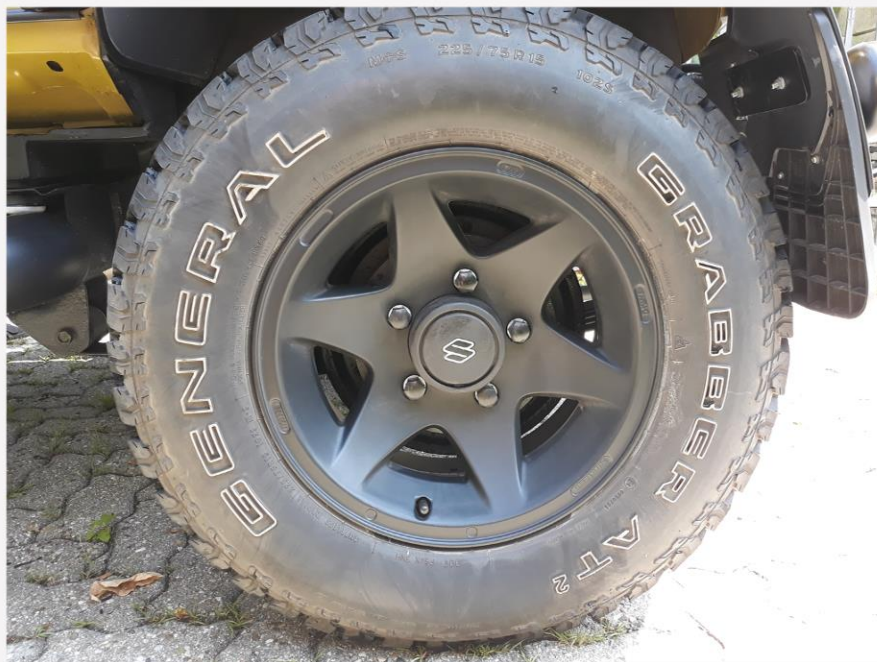
Original Suzuki Vitara Leichtmetallfelgen 7x15H2 ET3 generalüberholt und pulverbeschichtet mit General Grabber AT² 225/75 R 15 102S Bereifung, Suzuki Radschraubenabdeckung aus schwarzem Kunststoff.
