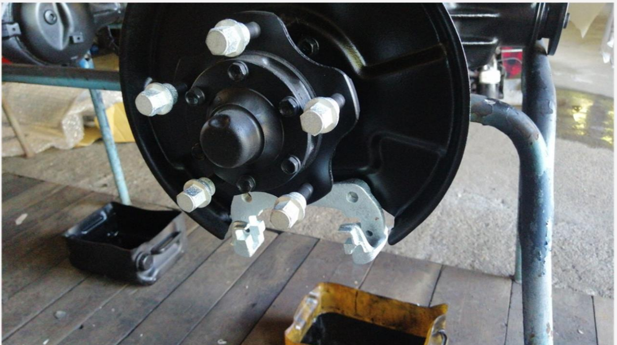
Achsen entrostet und neu beschichtet
