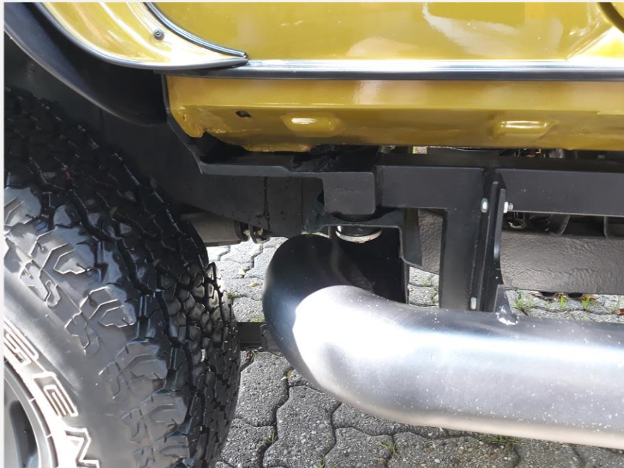
Adapterrahmen zwischen unteren Aufnahmepunkten Suzuki und oberen Aufnahmepunkten Mini Karosserie (verstärkt durch Fa Fischerleitner, (Foto hinterer Bereich).
