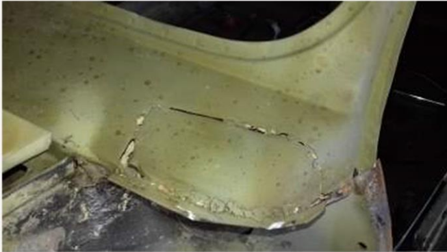
Prinz Heinrich Blech generalsaniert, schadhafte Stellen durch orig. Reparaturbleche ersetzt
