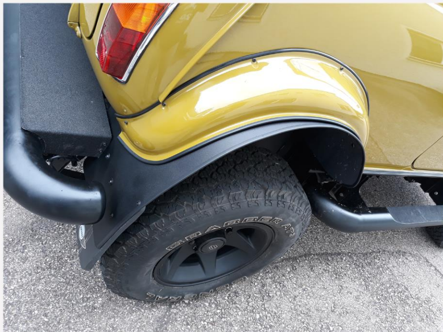
Austin Mini Gruppe 5 Verbreiterungen, mit Radlaufinnenverkleidung auf Bereifung laut STVO angepasst.
