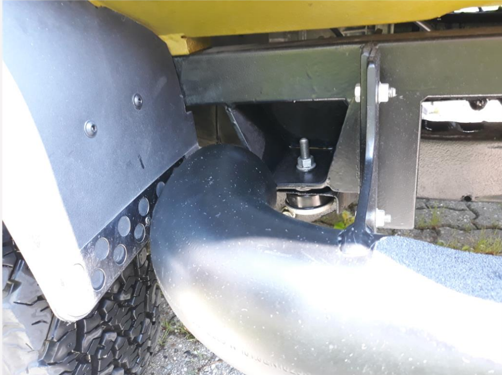
Adapterrahmen zwischen unteren Aufnahmepunkten Suzuki und oberen Aufnahmepunkten Mini Karosserie (verstärkt) durch Fa Fischerleitner, (Foto vorderer Bereich mit und ohne Abdeckung), mit seitlichem Unterfahrschutz / Seitenschweller mit Trittstufe.
