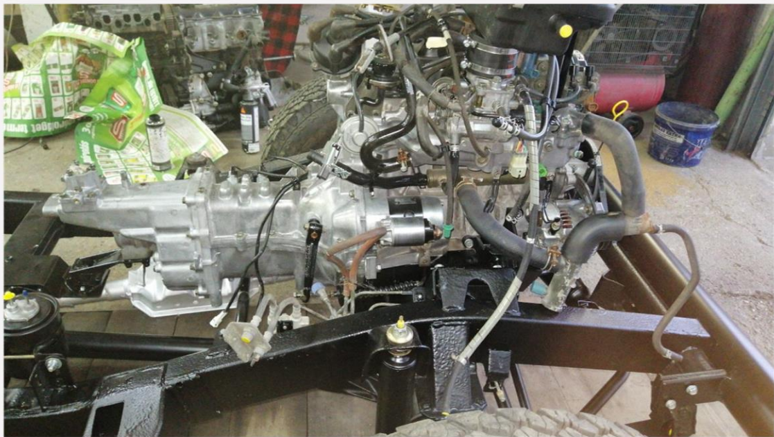
original Suzuki Motor generalüberholt, zerlegt, neu gelagert, neue Simerringe, alle Verschleißteile getauscht, neu abgedichtet, in originalen Suzuki Rahmen modifiziert eingebaut.
