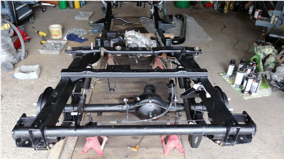
originaler Rahmen und Achsen sandgestrahlt und entrostet, spritzverzinkt, grundiert und pulverbeschichtet, Hohlraumversiegelt und mit Steinschlagschutz versehen, neue Fahrwerksaufhängung Blattfedern und Stoßdämpfer incl. Lager und Gummi
