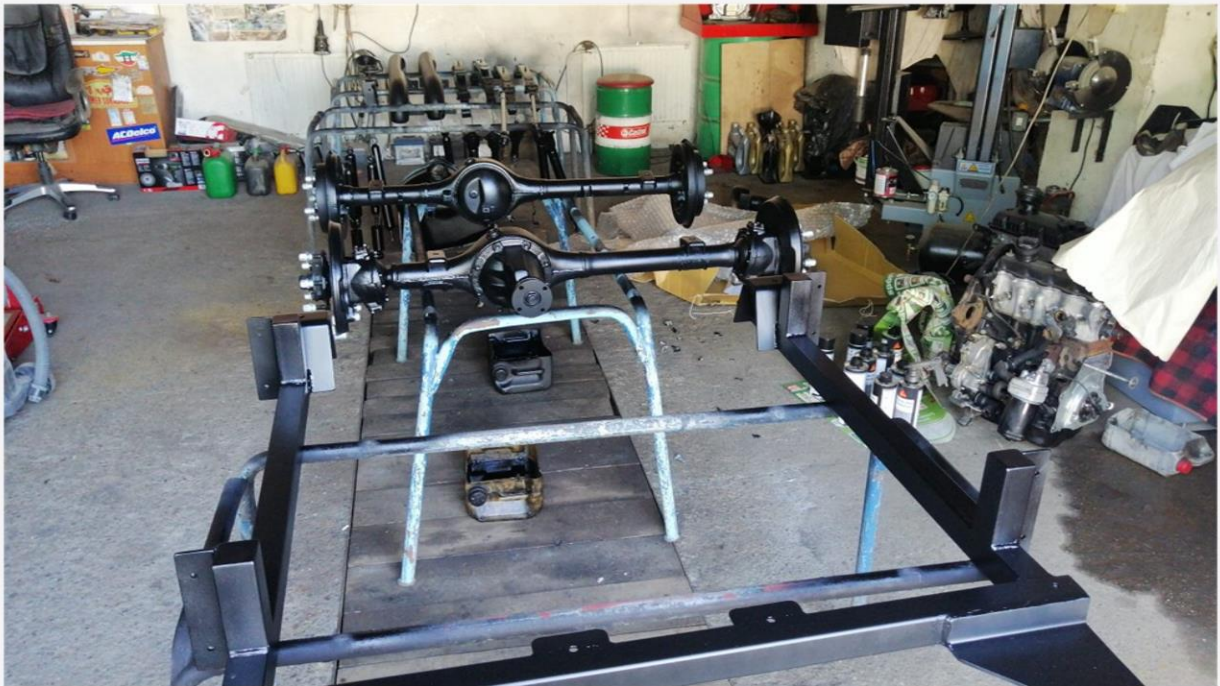
Gesamter Rahmen und Unterbau in alle Einzelteile zerlegt, neu lackiert und mit neuen Verschleißteilen neu aufgebaut.
