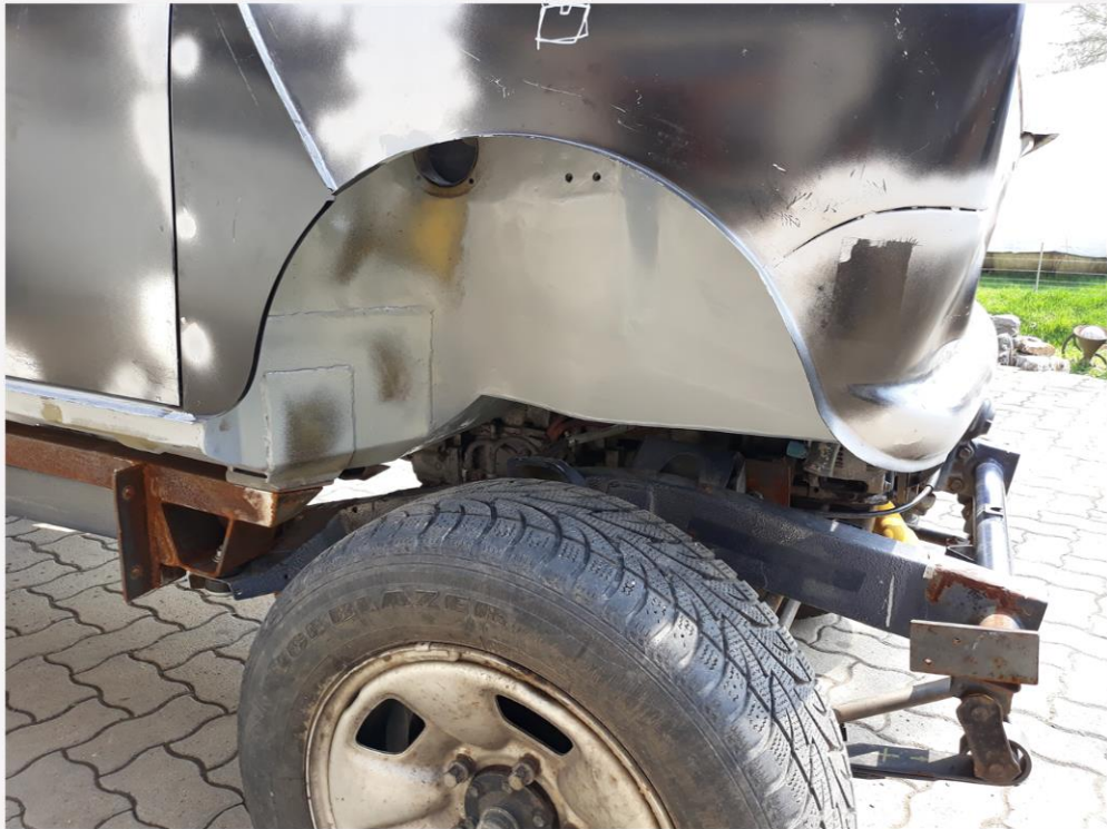
Schadhafte Stellen verschweißt, entrostet und spritzverzinkt. Kotflügel und Frontmaske durch Neuteile ersetzt. Frontschürze gecleant.
