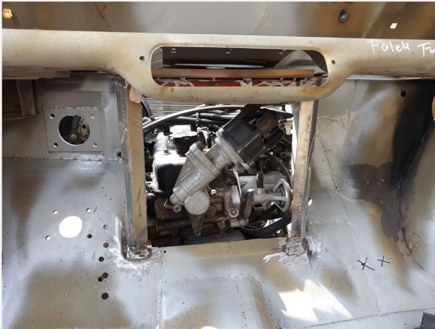
Techn. erforderliche Anpassungen der Karosserie verschweißt, entrostet und spritzverzinkt
