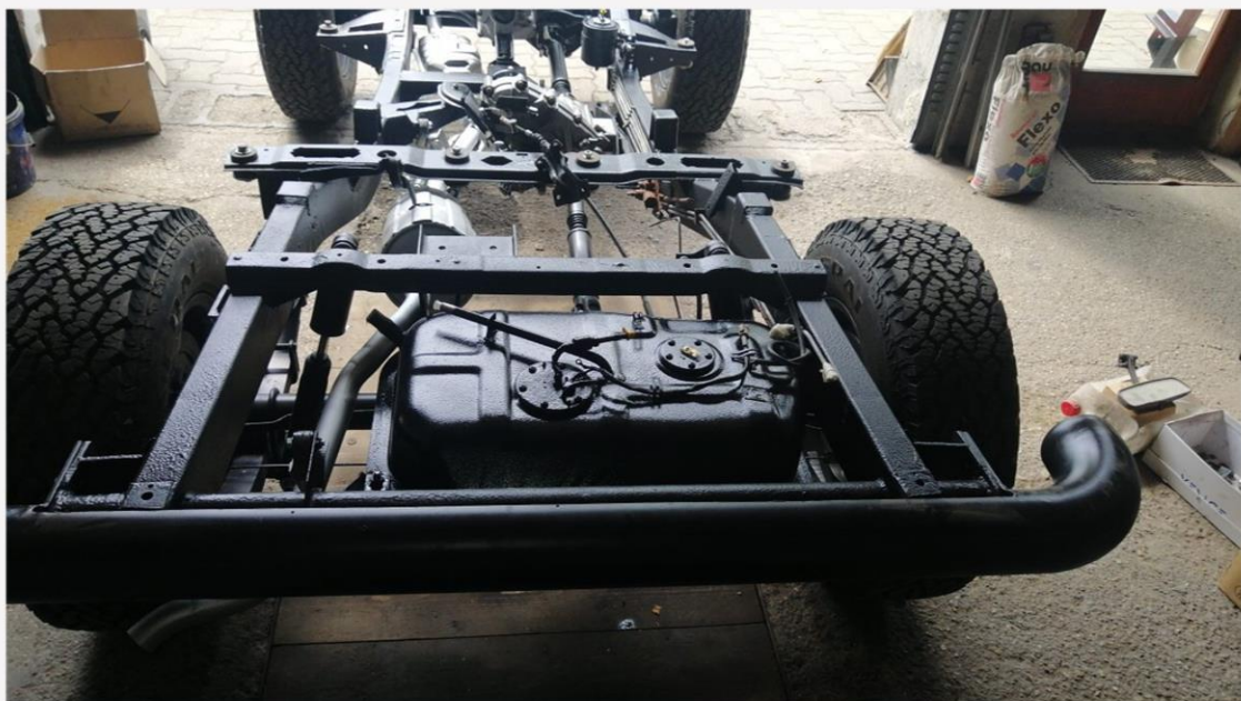
original Suzuki Tank samt Tankgeber und Benzinpumpe neu
