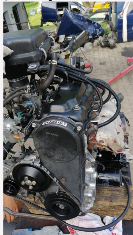
Anbauteile generalüberholt und neu lackiert
