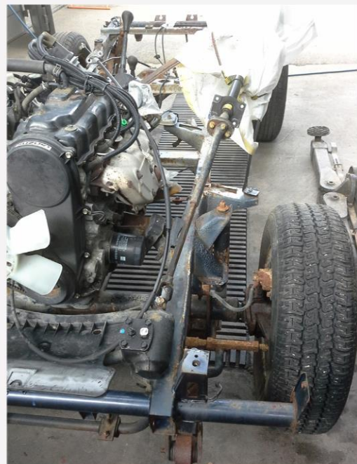
Basis : Suzuki Samurai Rahmen und Motor vor Restaurierung, Fahrgestell und Antriebseinheit Suzuki SJ413 Samurai BJ 1987
