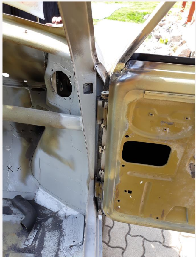
Unfallschaden an A-Säule behoben und durch originale Reparaturbleche ersetzt
