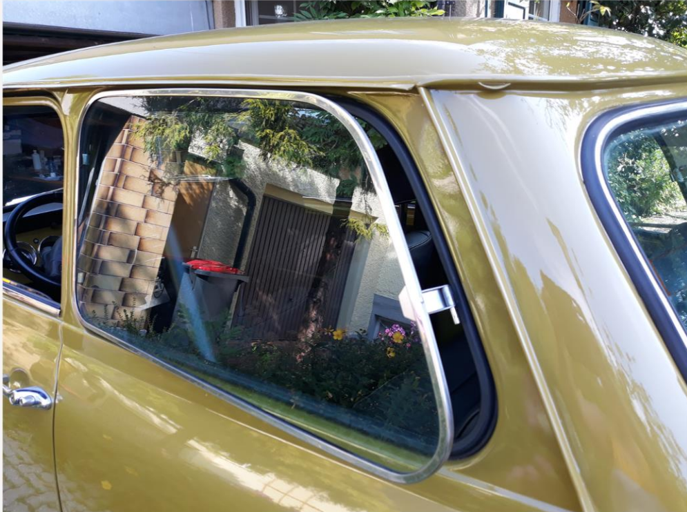
Seitenscheiben : original Mini Ausstellfenster mit neuen Dichtungen.
