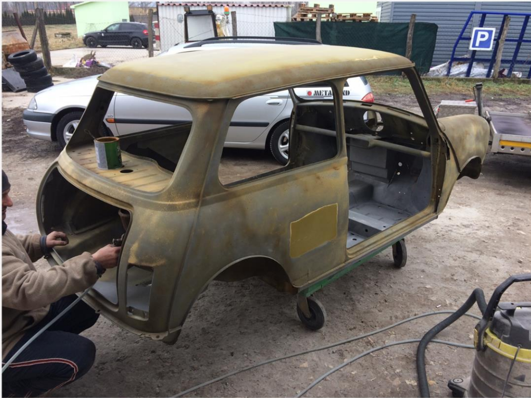
Karosserie mit Schutzbeschichtung
