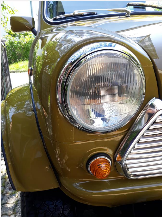
2 neue originale Austin Mini Scheinwerfer mit neuen Lampentöpfen sowie neuen Chromringen, neue originale Austin Mini Blinker mit Chromring.
