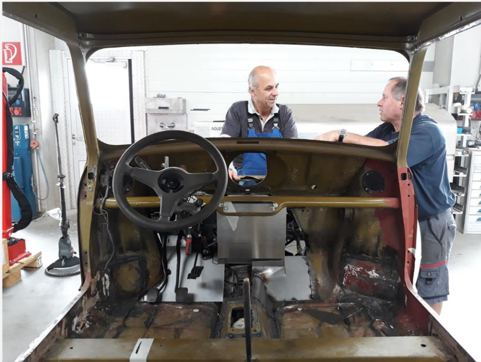
Anpassung des originalen Mini Feuerschutzblech an Suzuki Motor und Getriebe
