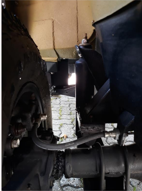
Bremsschläuche, Bremscheiben, Bremsbeläge, Stoßdämpfer, Blattfedern neu.
