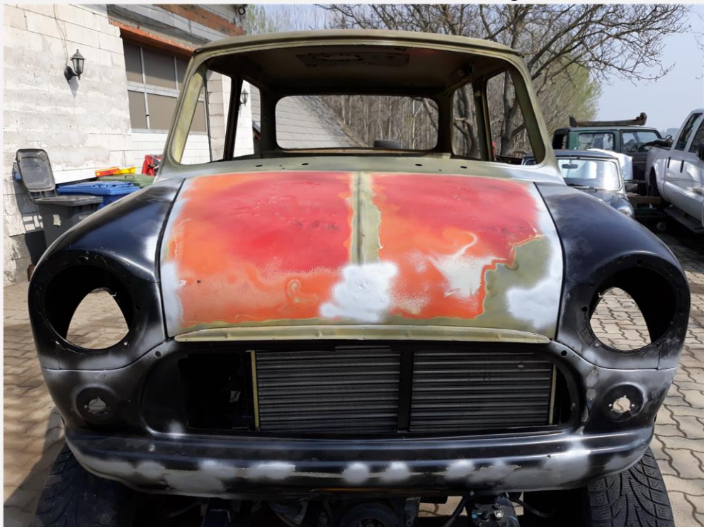
Schadhafte Stellen verschweißt, entrostet und spritzverzinkt. Kotflügel und Frontmaske durch Neuteile ersetzt. Frontschürze gecleant.
