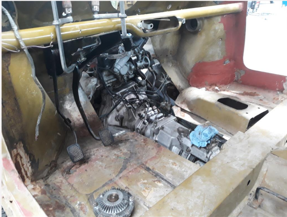
Anpassung des originalen Mini Getriebetunnels an das Suzuki Getriebe
